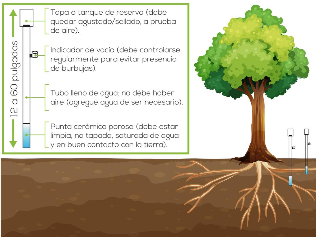
Fotografía 3. Diagrama de un tensiómetro y una estación de dos tensiómetros (<http://aglifesciences.tamu.edu/baen/wp-content/uploads/sites/24/2017/01/E-618S-Irrigation-Monitoring-with-Soil-Water-Sensors.-Spanish-Version.pdf>)
