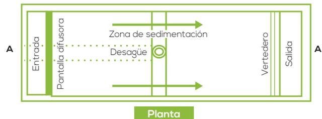
Figura. 25. Planta de un sedimentador
